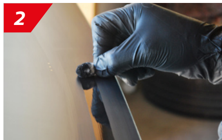
Secouer le flacon (1 min). Appliquer le produit avec l'applicateur fourni et laisser sécher
